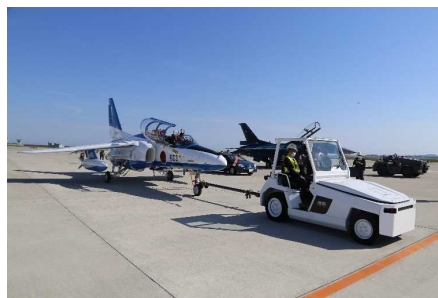
空自松島基地における電動式の航空機用けん引車の検証
