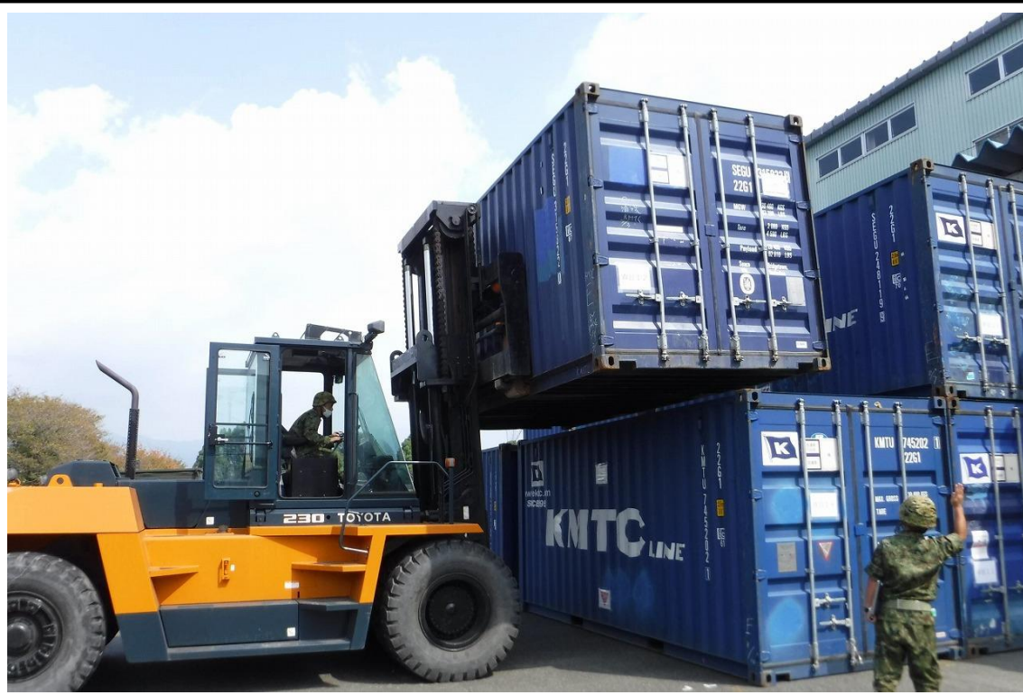
大型フォークリフトによるコンテナの荷役
