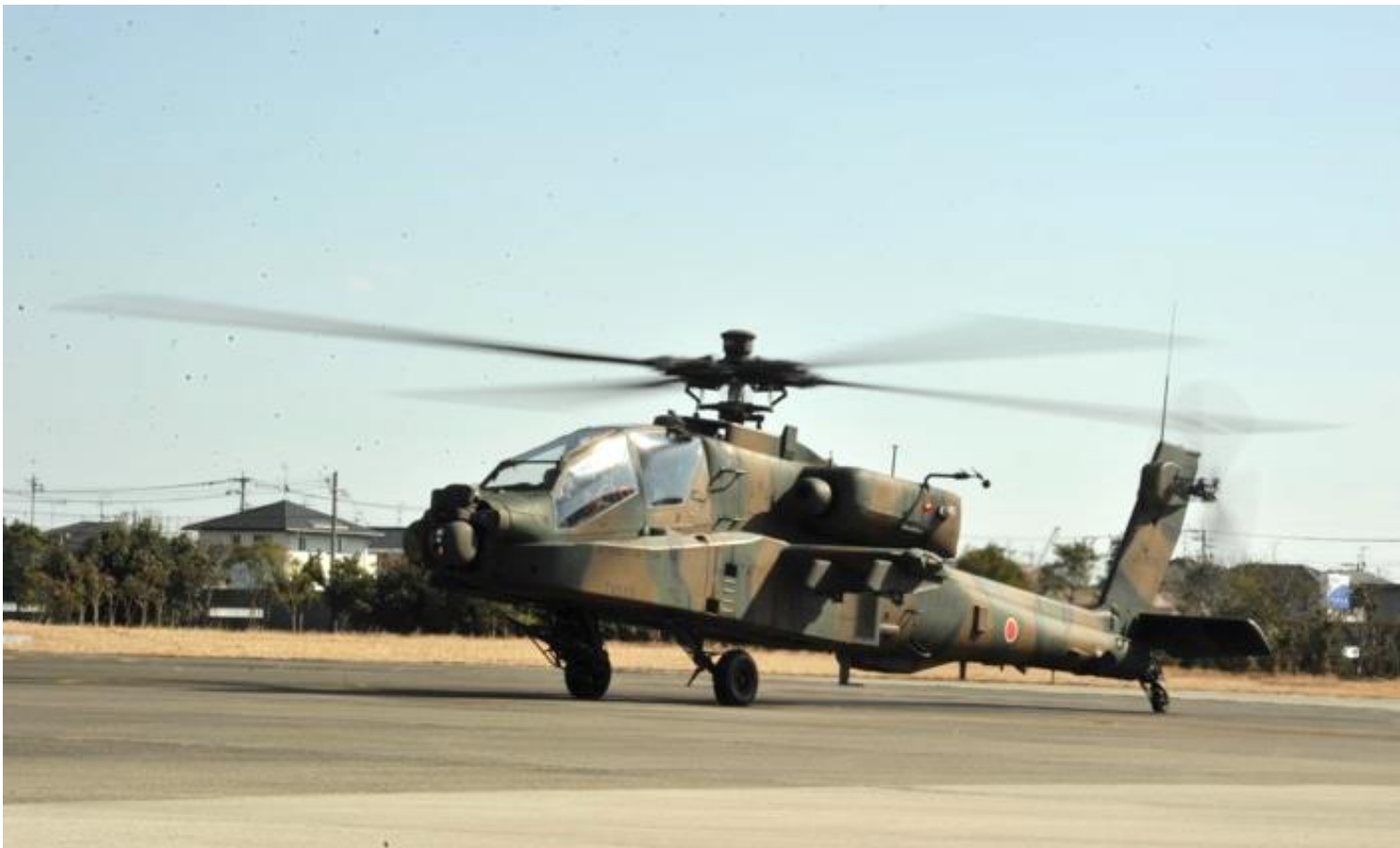
地上試運転の状況
