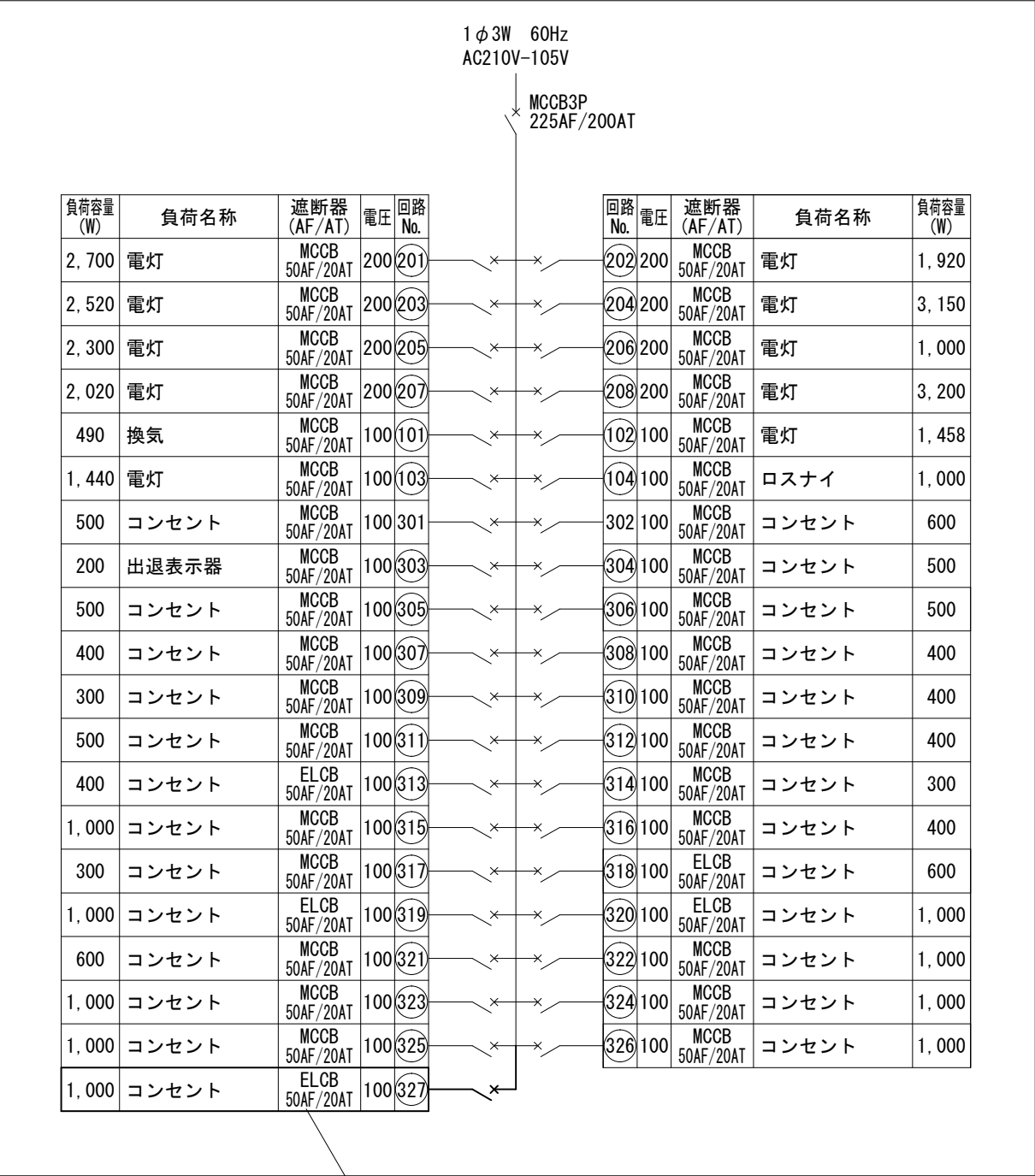
屋内電灯盤 (L-3A) (既設)
