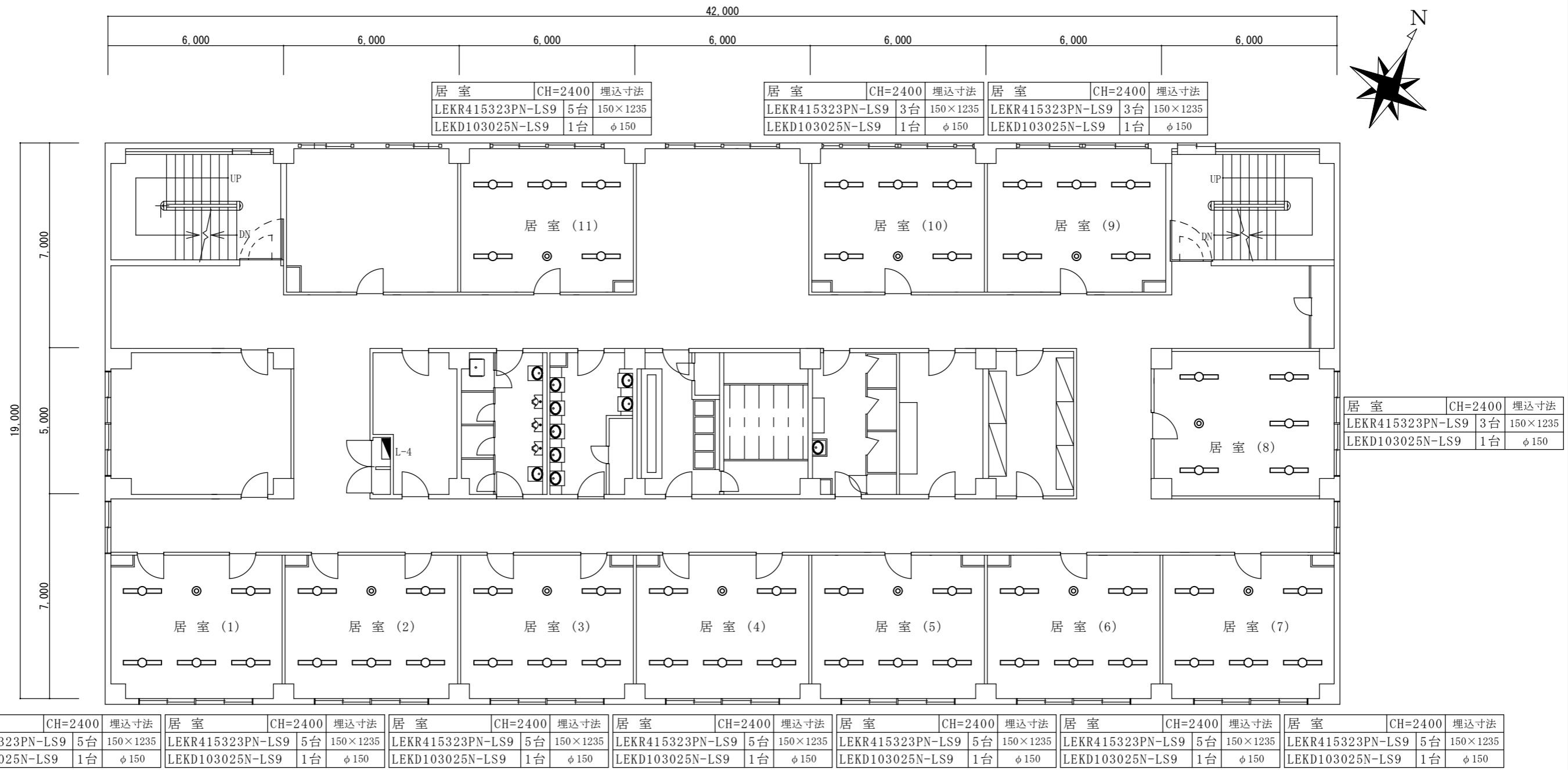
52号建物 4階照明設備平面図 (新設) S=1/150
