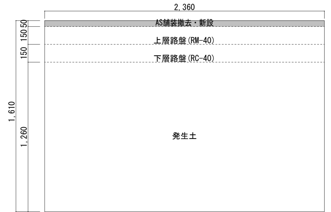
【新設】ハンドホール部 標準掘削図 S=1/20
