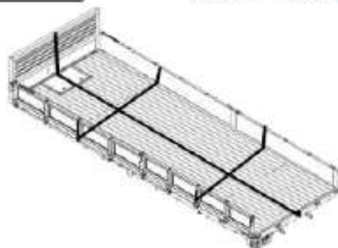
図5-特大型トラック外装部品及びフレームの解体・破砕図
