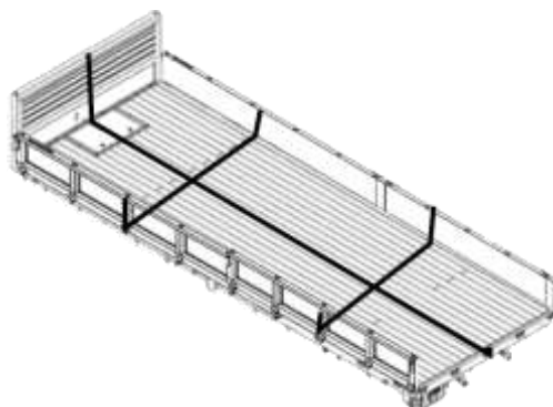
図5—特大型トラック外装部品及びフレームの解体・破碎図
