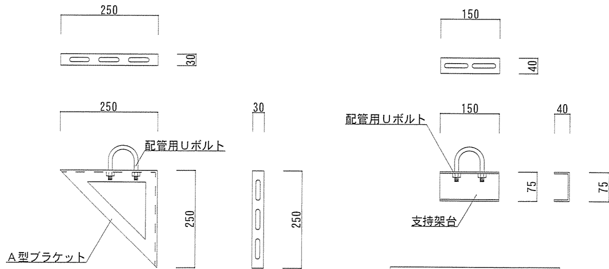
配管架台B詳細図 S=1/10
