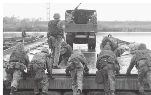
92式浮橋による重門橋の運航（遠賀川）
