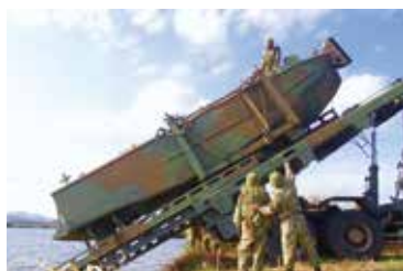
92式浮橋による門橋構築訓練 (動力ボートのへん水)
