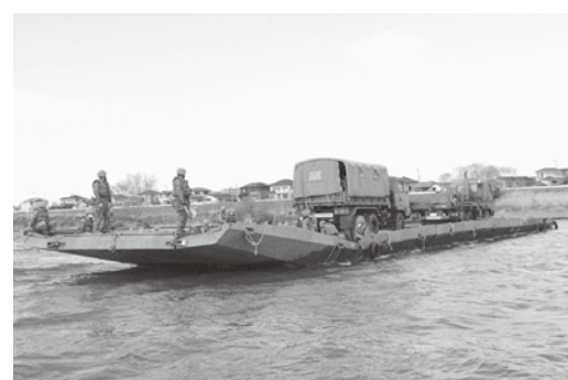
遠賀川での重門橋運航訓練
