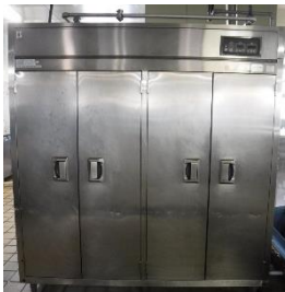
食器消毒保管庫
