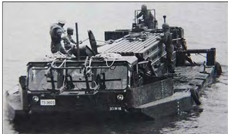
河川を航行する70式自走浮橋
