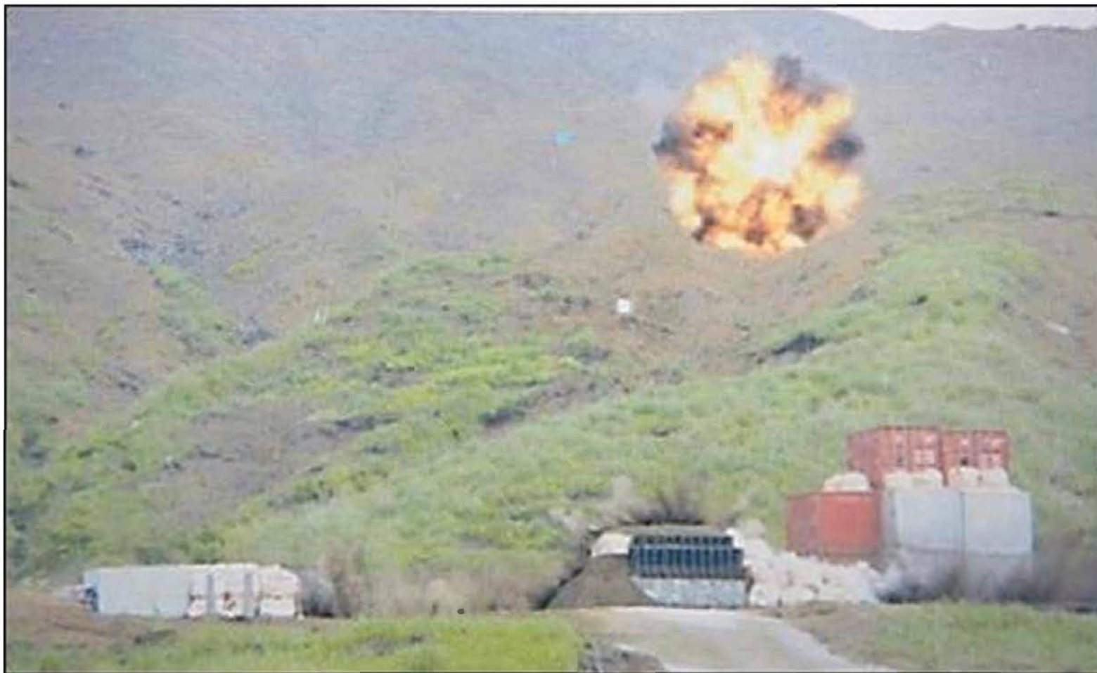
155mm榴弾砲の曳火による耐弾性の検証
