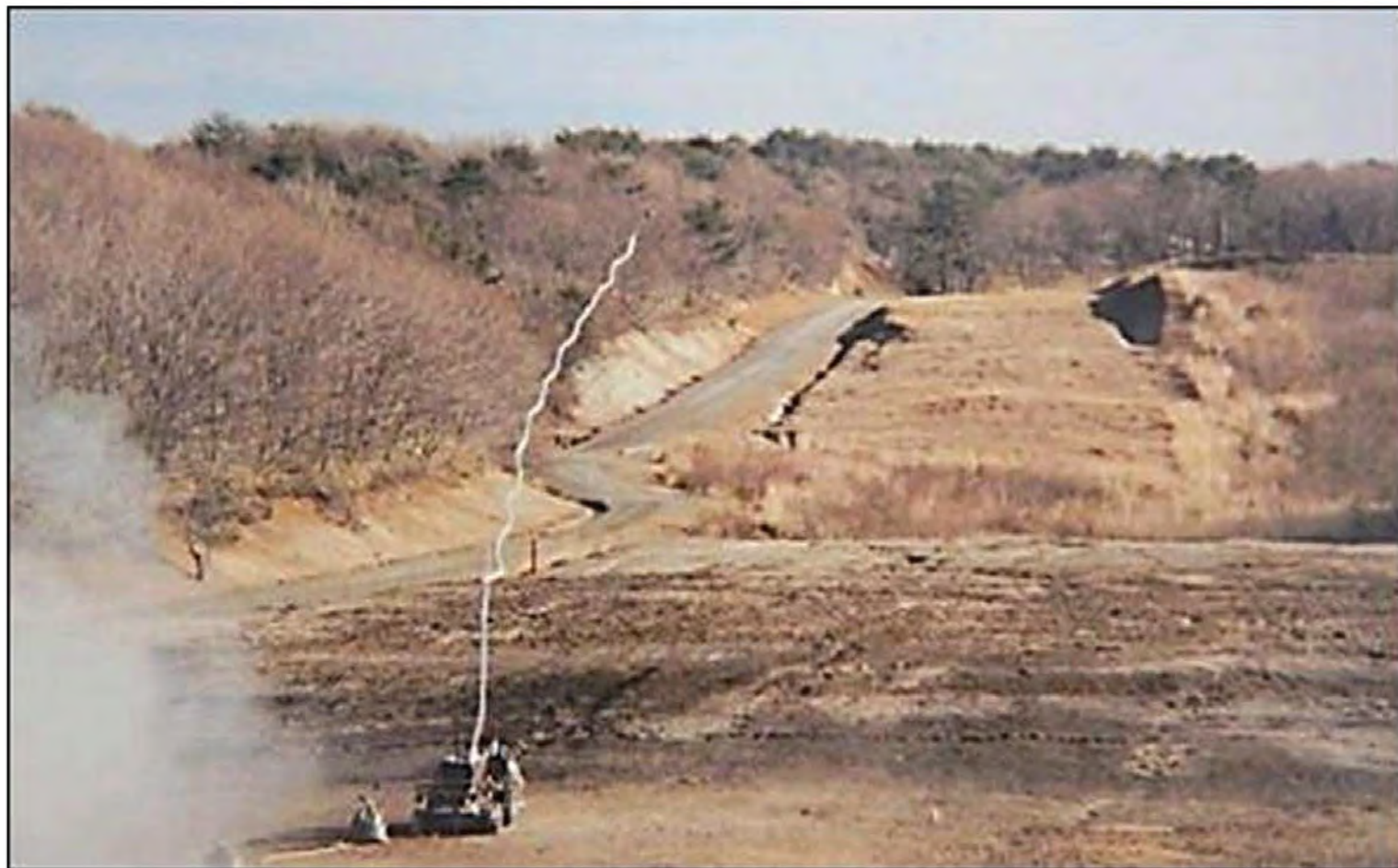
携帯障害処理器材により爆索を投射する瞬間
