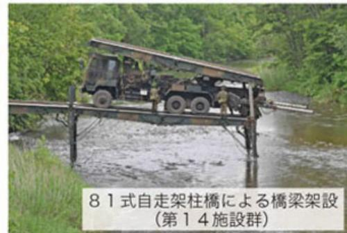
81式自走架柱橋による橋梁架設 (第14施設群)
