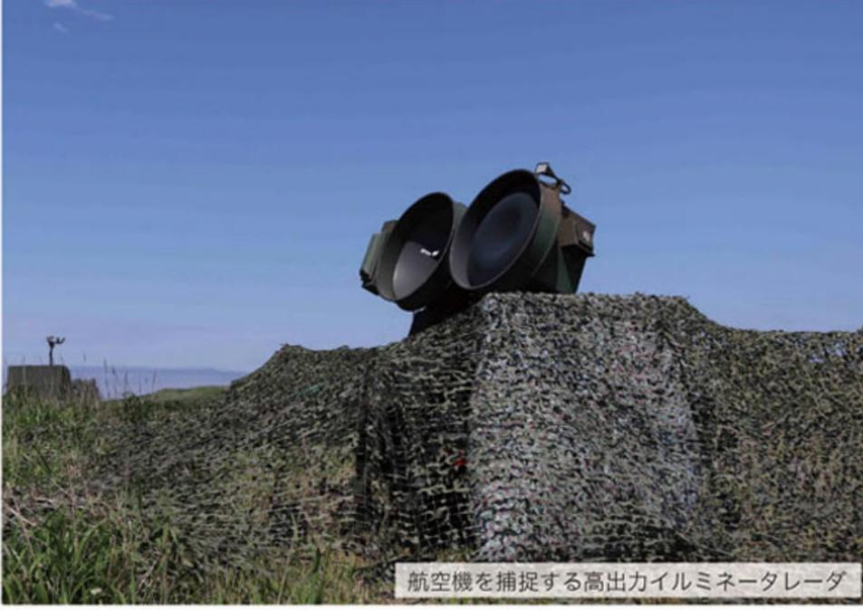
航空機を捕捉する高出力イリミネータレーダ
