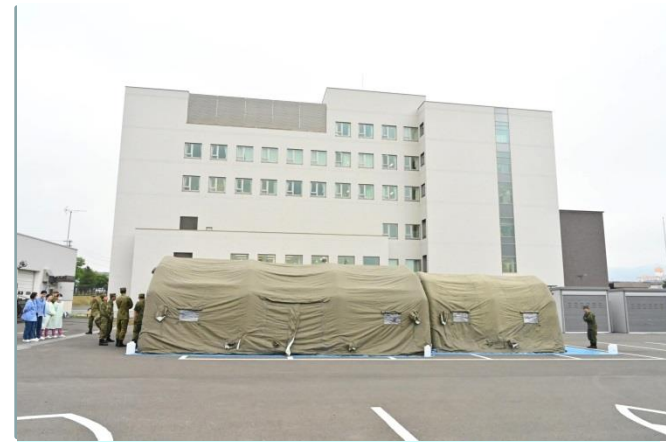
感染症対策用陰圧式エアテントシステム
