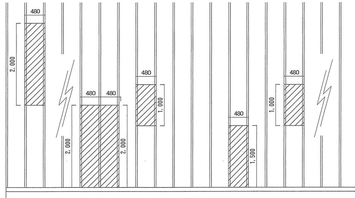
補修箇所詳細図 S=1: 50
