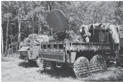
機動化した衛星通信所
