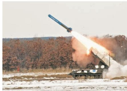
92式地雷原処理車による陣前の障害処理
