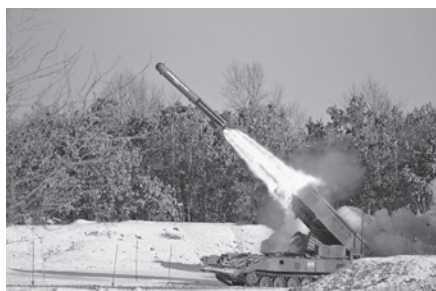
92式地雷原処理車による投射
