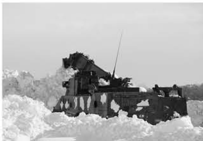
施設作業車による対戦車崖の処理
