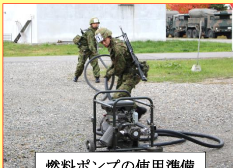
燃料ポンプの使用準備
