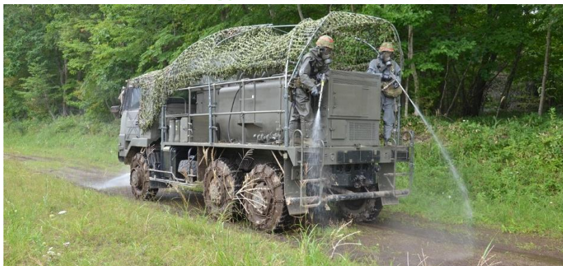
除染車による除染
