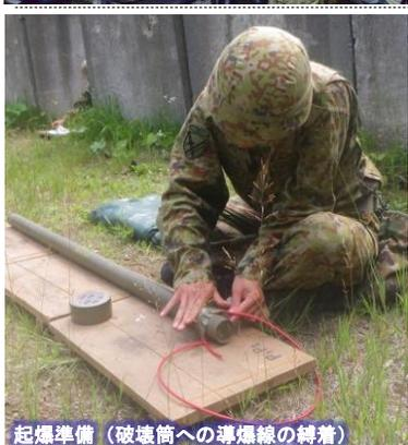
起爆準備（破壊筒への導爆線の縛着）
