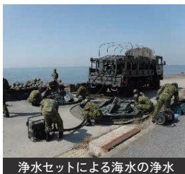
浄水セットによる海水の浄水
