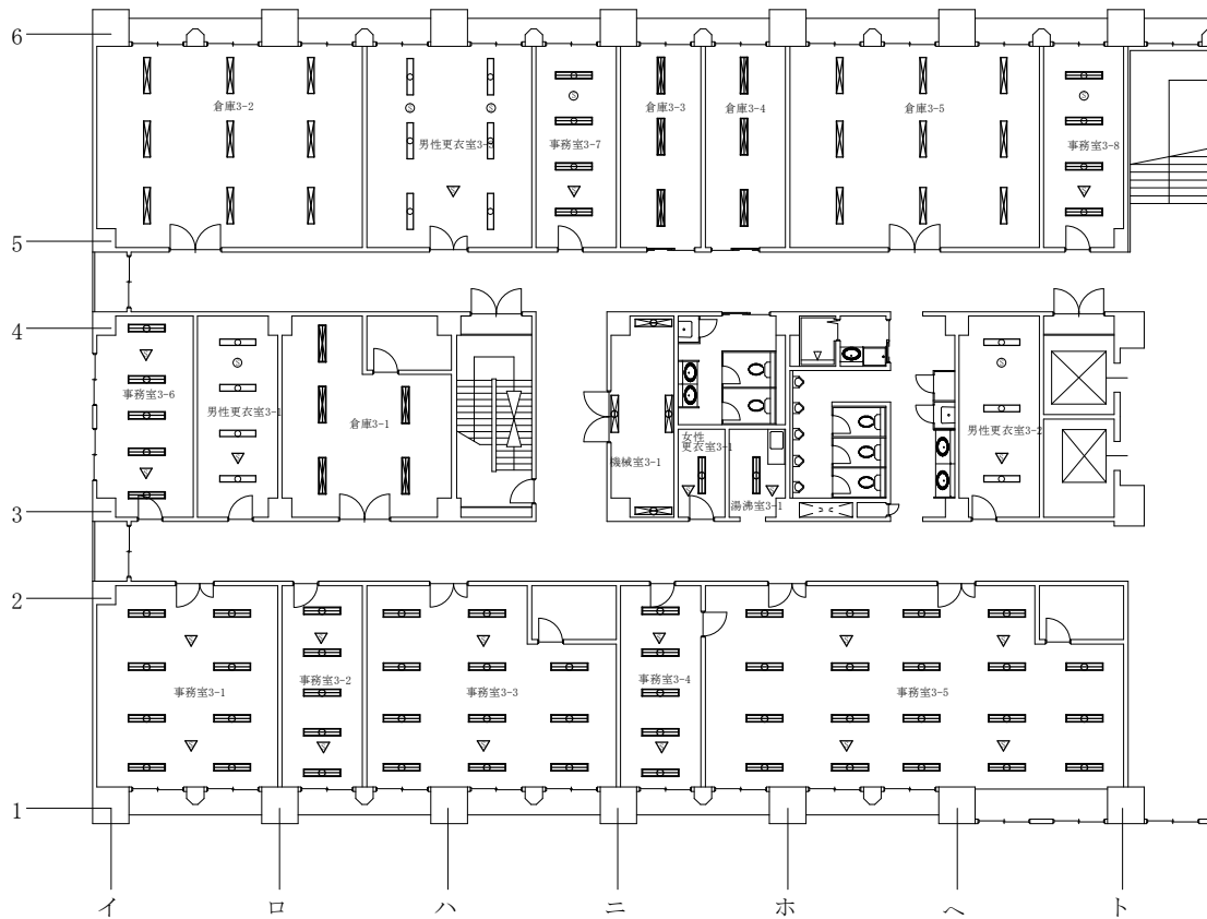
3階照明設備図 (1) S=1/200
