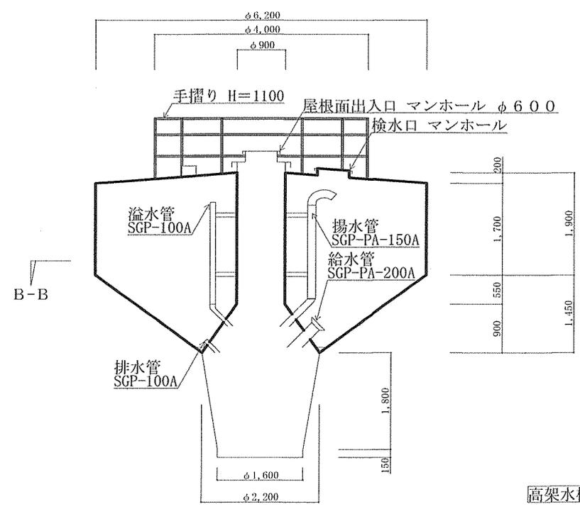
高架水槽タンク内部詳細図 S=1/100
