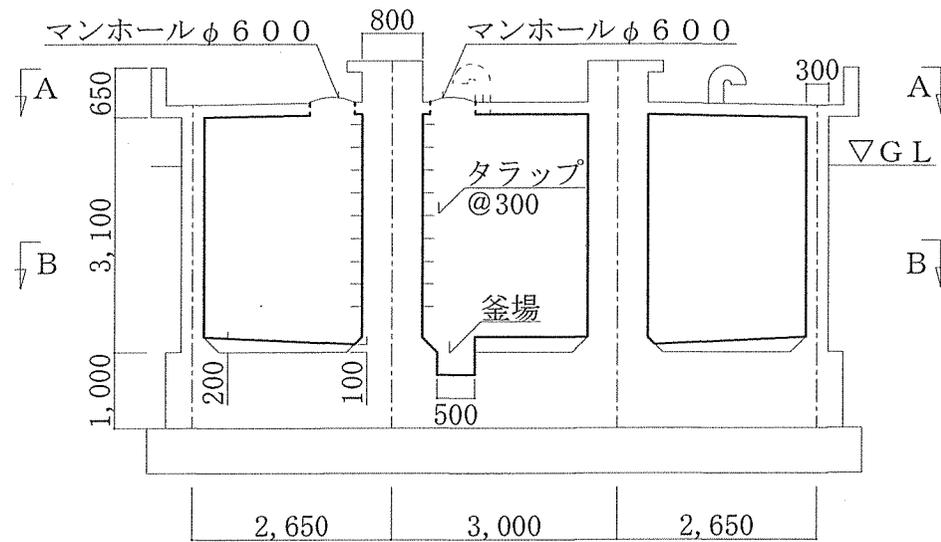
高架水槽下部受水槽断面図 S=1/100
