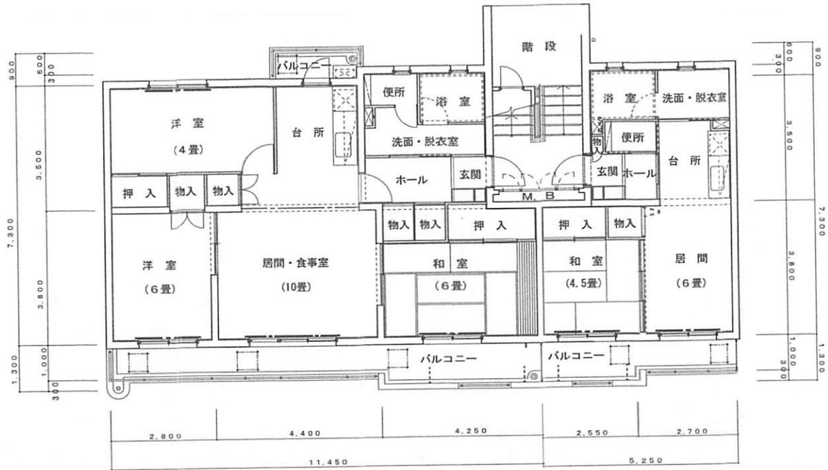
8号棟 平面図 (b・d規格)
