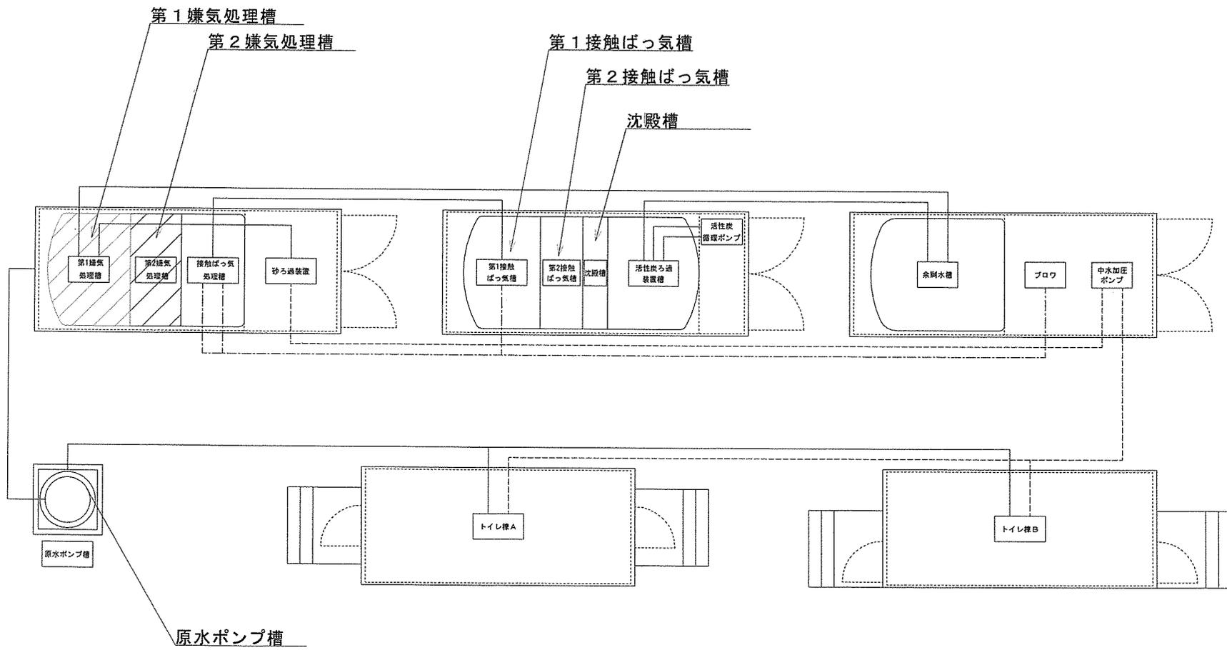
凡例 斜線部は、屎尿抜取槽を示す 計5,200L
