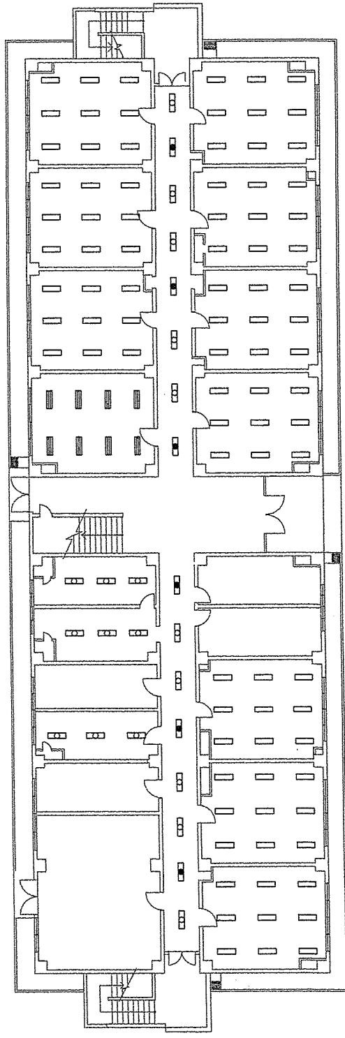
※平面図に表記されている照明器具は全て撤去する
