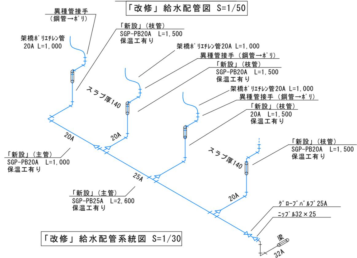
「改修」給水配管系統図 S=1/30
