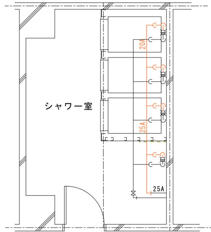
「改修」給湯配管図 S=1/50
