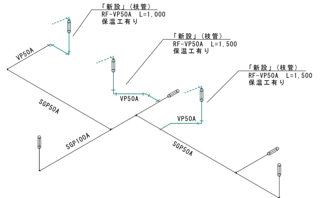
「改修」排水配管系統図 S=1/30
