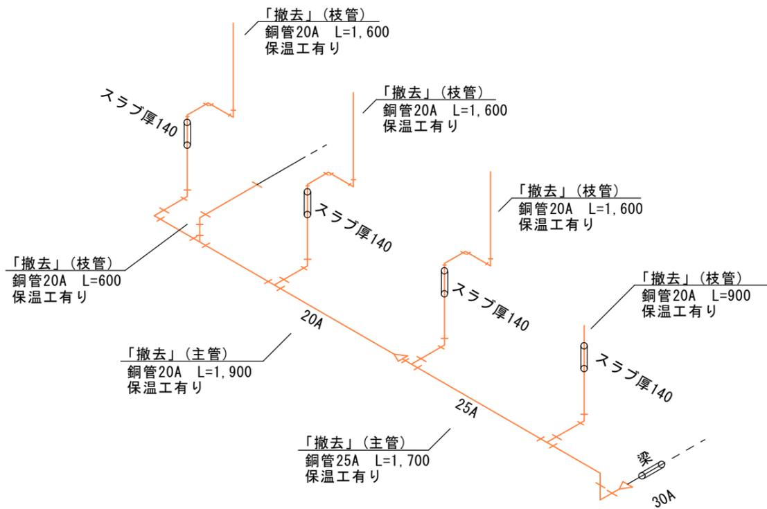
「撤去」給湯配管系統図 S=1/30
