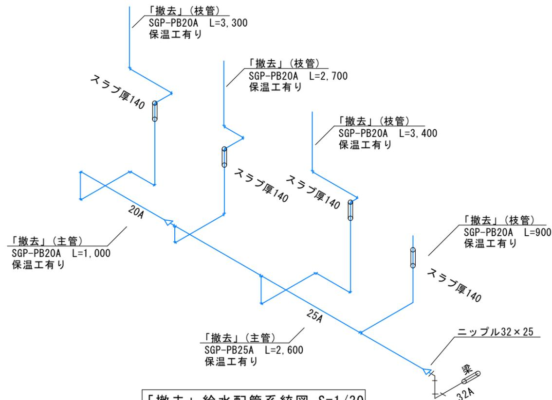
「撤去」給水配管系統図 S=1/30
