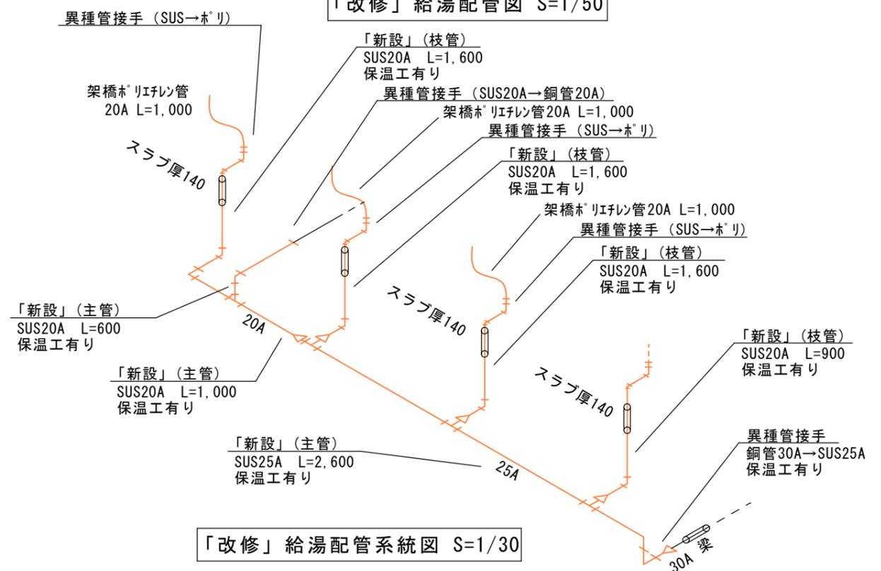
「改修」給湯配管系統図 S=1/30
