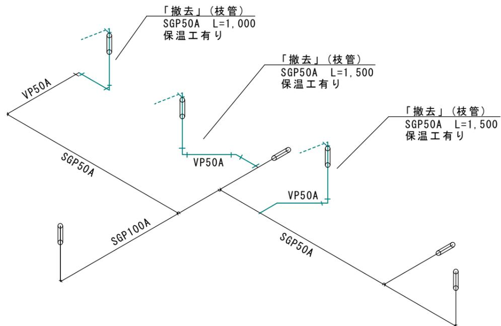
「撤去」排水配管系統図 S=1/30
