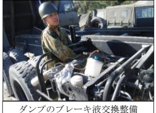
ダンプのブレーキ液交換整備
