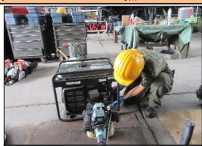
発電機の故障整備
