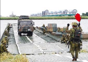
重門橋による大型車両の運航
