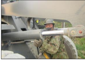
バケットローダの故障整備
