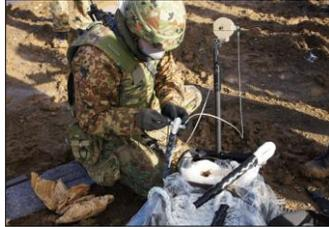
携帯障害処理器材の組み立て
