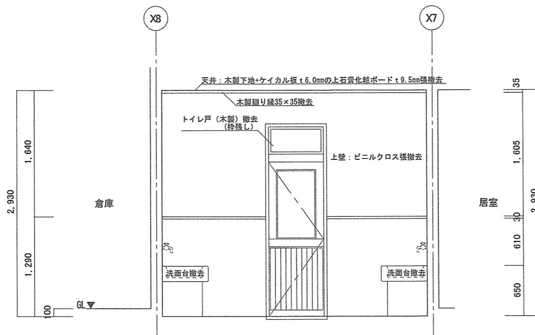
78号建物洗面C撤去展開断面図 S=1/50
