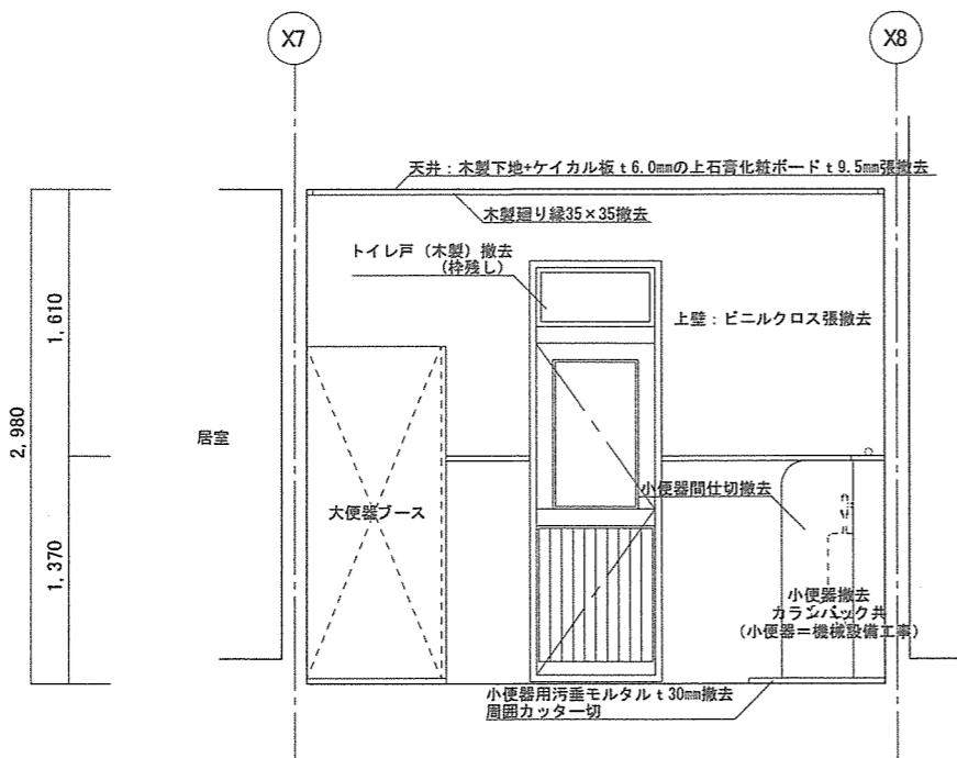
78号建物トイレA撤去展開断面図 S=1/50
