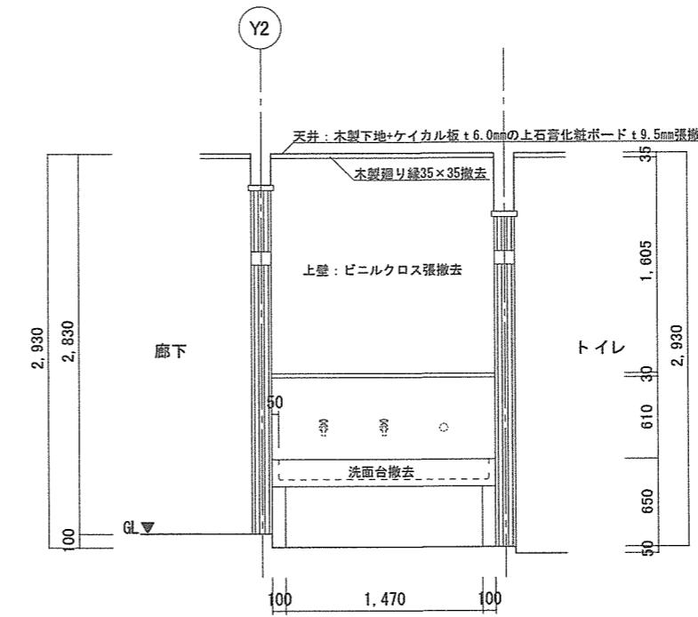
78号建物洗面B撤去展開断面図 S=1/50
