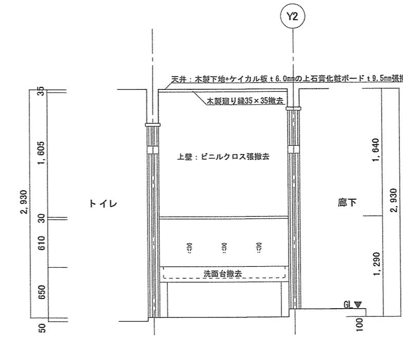
78号建物洗面D撤去展開断面図 S=1/50
