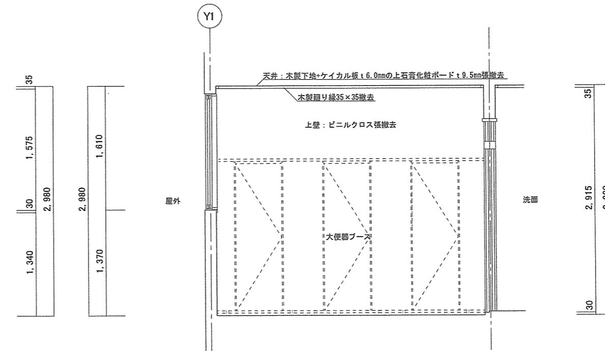
78号建物トイレD撤去展開断面図 S=1/50
