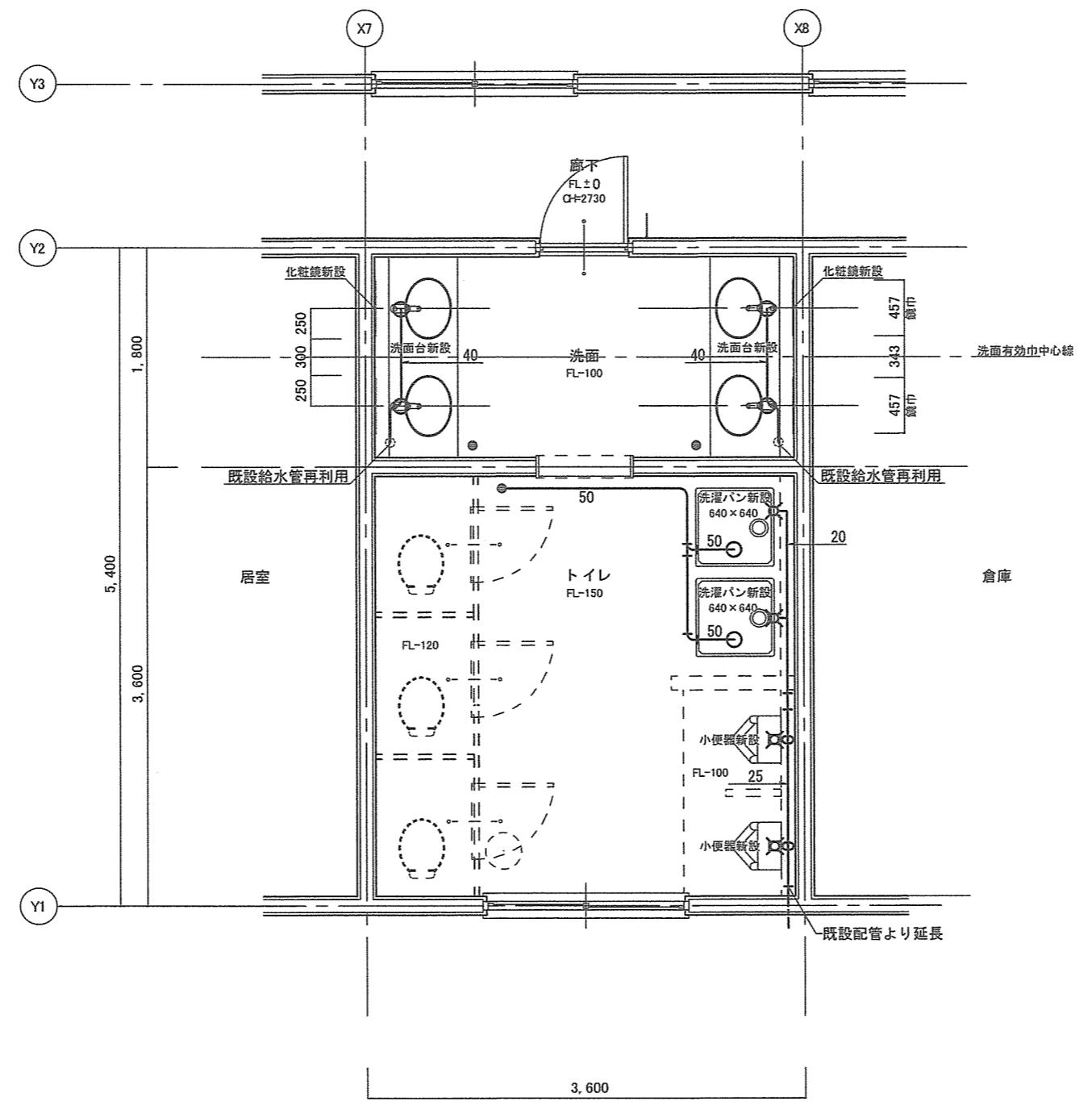
78号建物洗面・トイレ改修平面図 S=1/50
