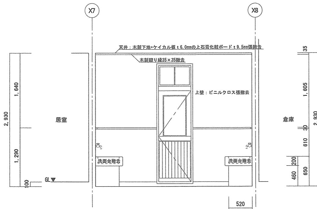
78号建物洗面A撤去展開断面図 S=1/50
