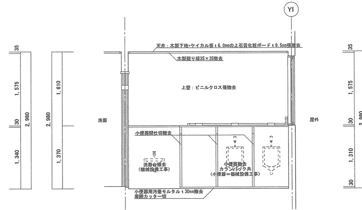
78号建物トイレB撤去展開断面図 S=1/50
