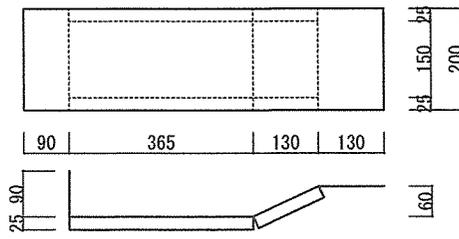
伸縮ジョイント平面・断面図 S=1/15
