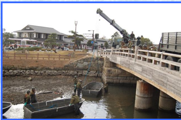
重レックでボートを吊り上げる
