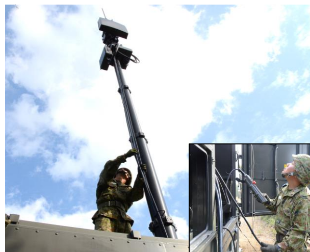
車載アンテナの昇柱
