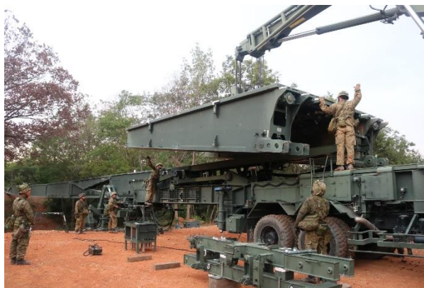
防衛準備間におけるO7式機動支援橋による橋梁架設（第3施設大隊）
