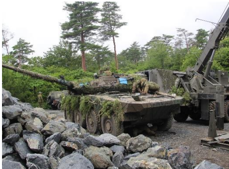
MCVの修理・整備
