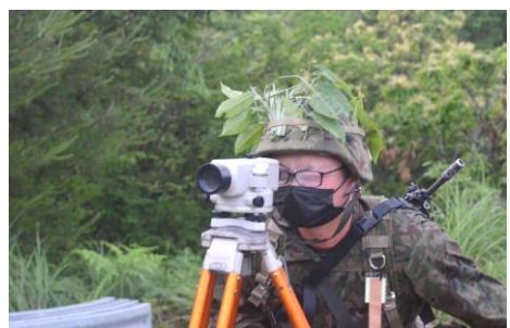
07式機動支援橋架設のため近岸と遠岸の高低差を測量する隊員
