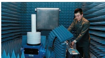
電波暗室でのアンテナ・レーダ断面積測定
