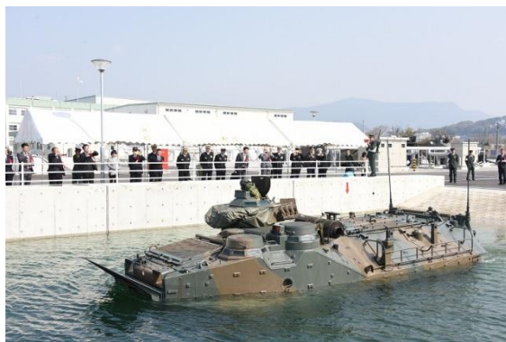
入水点検槽を試走するAAV7
