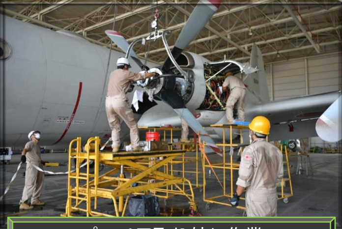
プロペラ取り外し作業
