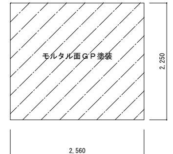
上板橋宿舍和室天井伏せ図 S=1:50
