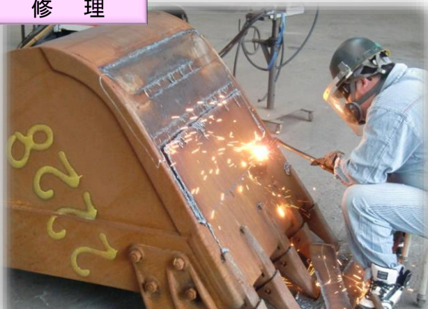
油圧ショベルバケット修理（工作工場）
