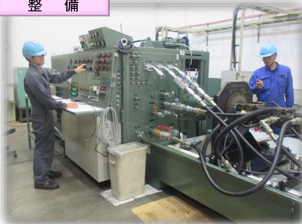
油圧機器試験（整備工場）
