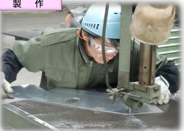
アルミ板切断（工作工場）
