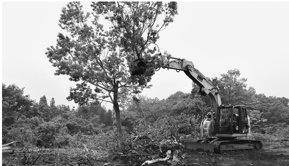
リース品の伐倒・集積アタッチでの伐木
