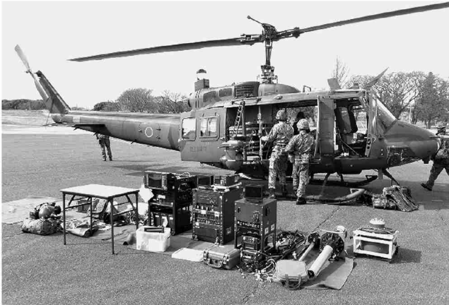
映像伝送装置の載せ替え作業
